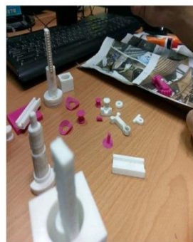
圖三：可變壓縮比引擎之構件
