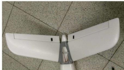
圖(5)中，V型尾翼控制機身水平轉彎及上升或下降。
