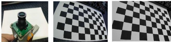
圖1、鏡頭樣式 圖2、鏡頭校正(前) 圖3、鏡頭校正(後)
