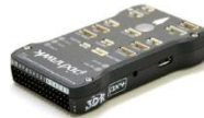
圖(2)中，經由飛控板轉換為水平飛行模式，因手動控制時不易平衡穩定。
